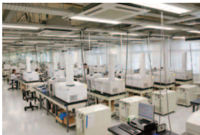
数千種類の細胞内代謝物質を一斉に測定できるCE/MS。IABが開発したメタボローム研究の新兵器
