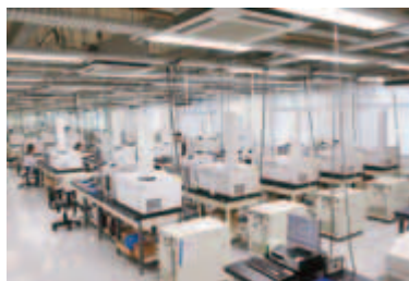
数千種類の細胞内代謝物質を一斉に測定できるCE/MS。IABが開発したメタボローム研究の新兵器
