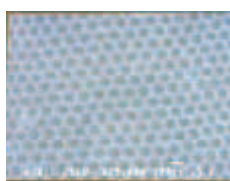
超流動性制御実験・ジョセフソン素子開発に使用するポーラスアルミナのナノ細孔アレイ
